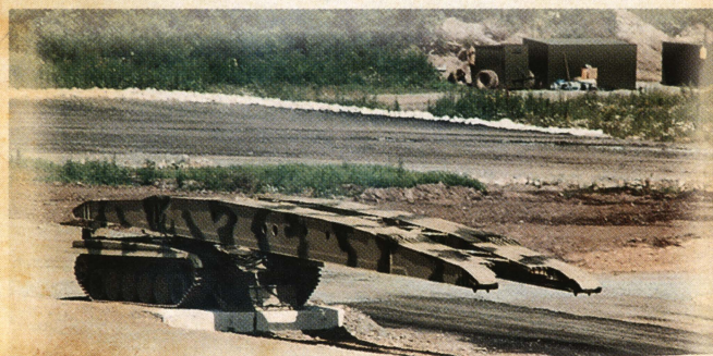
МТУ-72 укладывает разложенный мост на препятствие.
