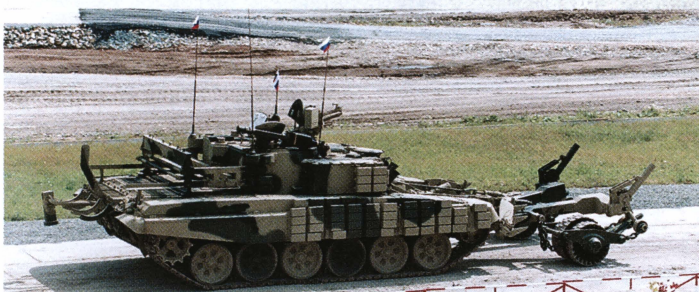
Боевая машина разминирования БМР-3М с тралом КМТ-7. Хорошо видна грузовая платформа для перевозки трала в транспортном положении.
